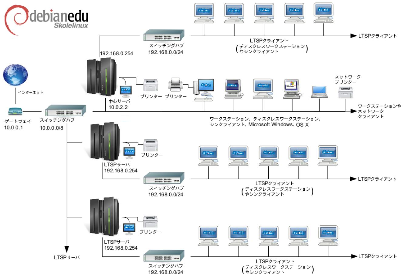
図はネットワーク接続形態の例です。Debian Edu / Skolelinux のデフォルトでは、ネットワークに通常のワークステーションや LTSP サーバー（それと関係するシンクライアントやディスクレスワークステーション）は複数想定されています。ただし「主サーバーは一つだけ」です。ワークステーションの数はお好みで設定できます（無くてもいいですし、多数でも大丈夫です）。LTSP サーバーについても同様で、それぞれが別のネットワークを構成するため、クライアントと LTSP サーバーの間の通信が他のネットワークサービスに悪影響を及ぼすことはありません。LTSP の詳細は [別の章の HowTo](#)をご覧ください。
