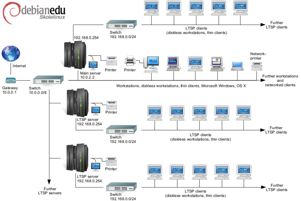
该图是假设网络拓扑草图。缺省设置的 Skolelinux 网络假设一个（并且只一个）主服务器，允许包含常规工作站和 LTSP 服务器（以连接瘦客户端和/或无盘工作站）两者。工作站的数目可大可小如你所需（从一个没有到大量启动的）。这同样适用于 LTSP 服务器，其每个是在分开的网络因而客户端和 LTSP 服务器之间的流量不影响其余的网络服务器。
