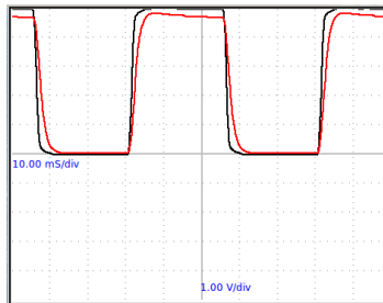
FIGURE 2.29 – Intégration à 20 Hz . R = 1\text{ k}\Omega et C = 1\text{ }\mu F
