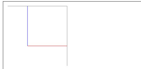
TikZ 最基本的路径为两点之间连线，如  $(\langle x_1 \rangle, \langle y_1 \rangle) -- (\langle x_2 \rangle, \langle y_2 \rangle)$ ，可以连用表示多个连线（折线）。连续使用连线时，可以使用 `cycle` 令路径回到起点，生成闭合的路径。
